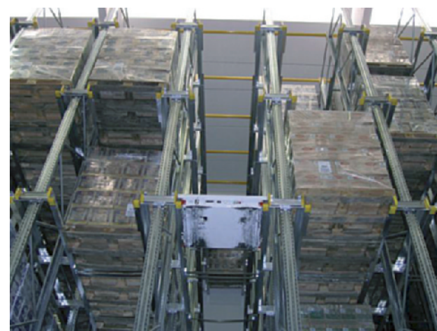
Sistema con satelliti gestiti da carrelli retrattili a grande elevazione (cortesia Madel Ravenna. Satelliti Esatroll).
