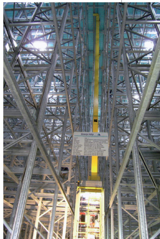
Magazzino autoportante altezza 24 metri con sistema trasloelevatore con satellite. (Cortesia Metalsistem – Gorenje)
