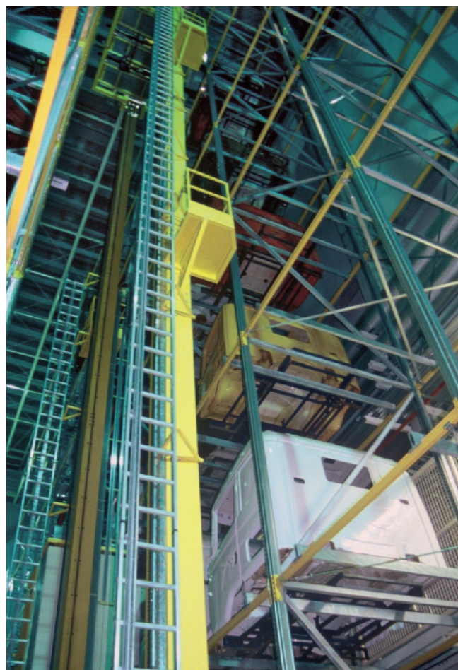
Buffer di asciugatura impianto verniciatura Scania. (Cortesia IBL)
